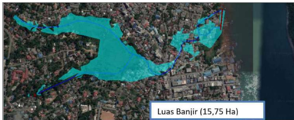
Gambar 11. Hasil pemodelan kondisi eksisting Q 25 tahun
