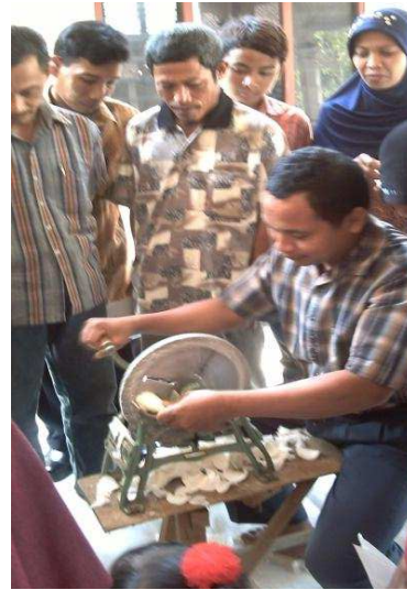
Gambar 4. Pengecilan ukuran singkong dengan perajang singkong
